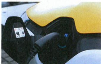
Schließen Sie jetzt zuerst die Verbindung am Fahrzeug an, anschließend am Ladepunkt. Stecken Sie dazu das Ladekabel immer fest und möglichst gerade in einem Zug ein. Starten Sie dann den Ladevorgang: an der Ladesäule (je nach Säule z.B. mit Ladekarte (s. Handschuhfach), Ladechip, Schlüssel oder Anruf (s. Säule), in der App oder eventuell automatisch.
